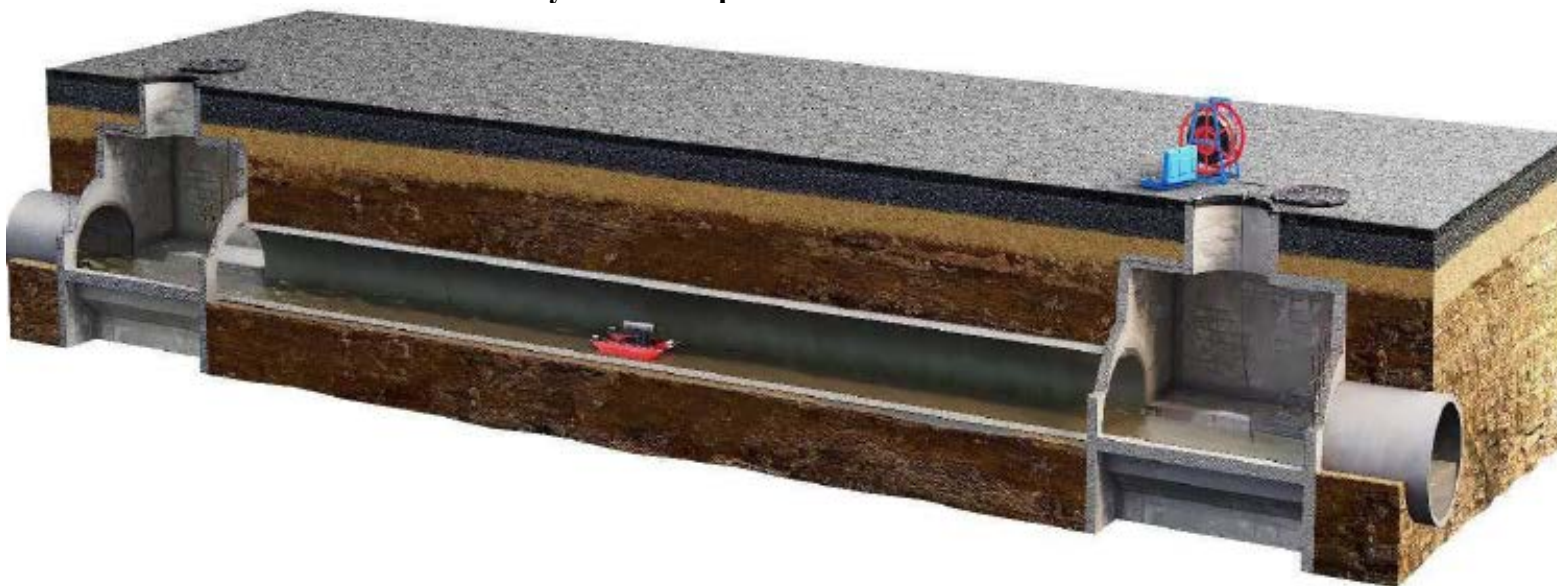
Рисунок 2.4 – Телеинспекция робототехническим оборудованием
