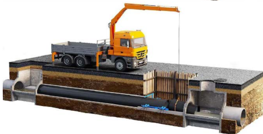
Рисунок 2.8 - Протяжка резьбовых модулей (труб) типа СПИРОЛАЙН при помощи кондуктора
