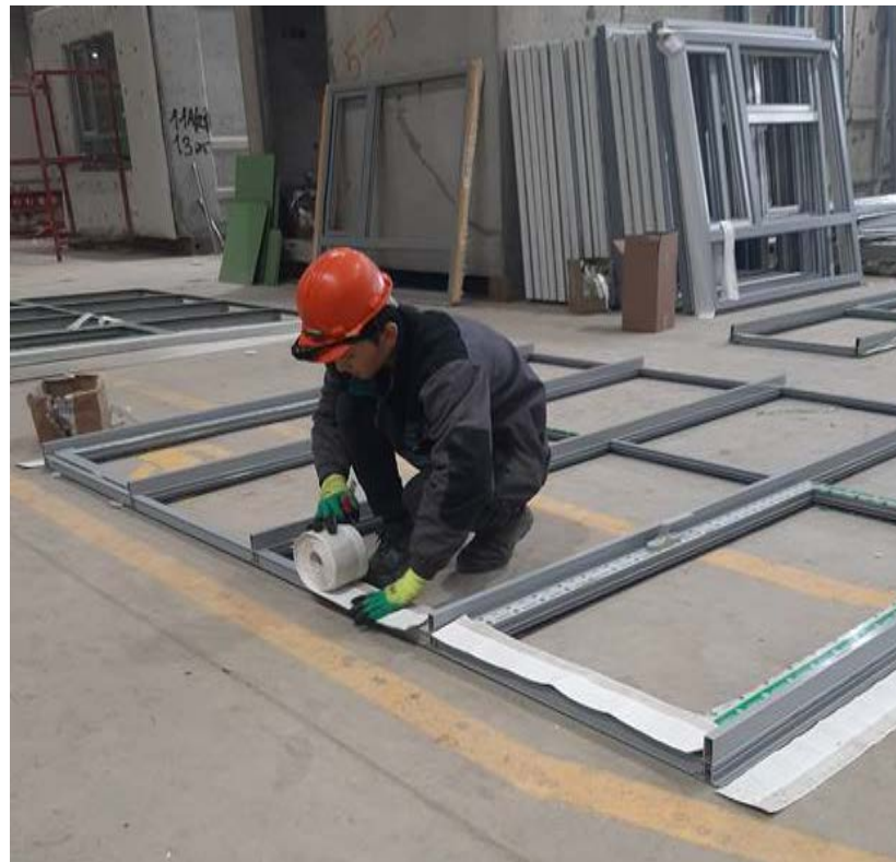
Рисунок 7 - Проклейка пароизоляционных лент
