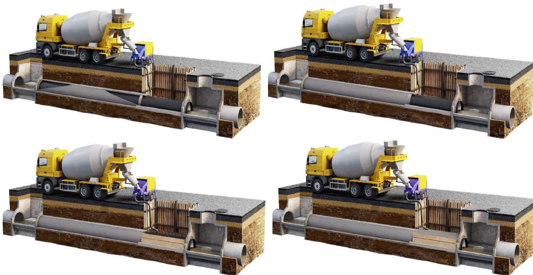
Рисунок 2.10 - Тампонирование междатрубногo пространства и свода коллектора
